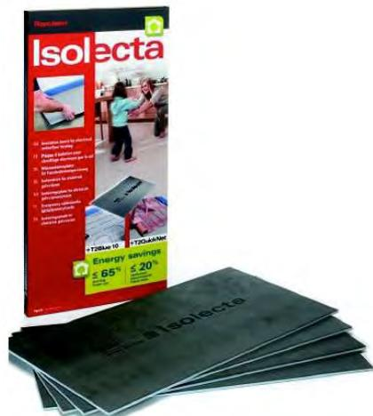
Isolecta- eine leichte Verlägedämmplatte mit beidseitiger glasfaserverstärkter Zementschicht als Untergrund zur Isolierung nach unten. Weniger Energieverbrauch ,schnelles aufheizen sind die Vorteile von Isolecta, da der Wärmeverlust nach unten wesentlich reduziert wird. Ideal geeignet zur Isolierung von Wintergärten und Böden mit geringer Aufbauhöhe.
