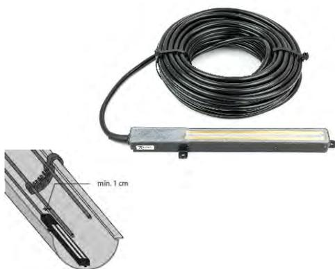
Digitaler Dach- und Dachrinnenfühler zur Erfassung von Feuchte und Temperatur inkl. 15 m Fühlerleitung 4x1mm<sup>2</sup>. Durch Verwendung von digitaler Technik und unter Berücksichtigung des Leitungsquerschnittes, kann die Fühlerleitung bis 500m verlängert werden.
