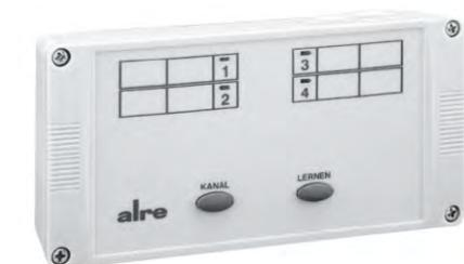
4-8 Kanal Funk-Temperaturregler (Empfänger) zur Montage im Heizkreisverteiler. Bis zu 4 Stellantriebe je Kanal direkt anschließbar, inklusive Pumpenmodul. Master-Slave Betrieb, Erleichterung des Anlernvorganges durch abnehmbares Bedienteil mit Kanaltasten ( 9V Blockbatterie nötig ). Anschluss einer externen Antenne möglich.
