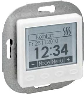
Digitales Raum- und Fußbodenthermostat mit beleuchtenden Display und 4 Touch-Tasten. Individuelles Tages-Wochenprogramm einstellbar. Verwendbar als Raumthermostat, Fußbodenthermostat oder Kombiregler.
