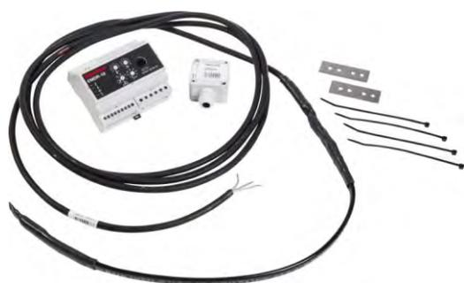
Das EMDR-10 gewährleistet einen energieeffizienten, stromsparenden Betrieb für Frostschutz an Dach und Dachrinne. Es ist mit einem Temperatur- und einem Feuchtefühler ausgestattet. Die Beheizung wird nur aktiviert, wenn sowohl Feuchtigkeit als auch Temperaturen unter 0 °C erkannt werden. So wird ein ungehinderter Abfluss des Schmelzwassers ermöglicht.
