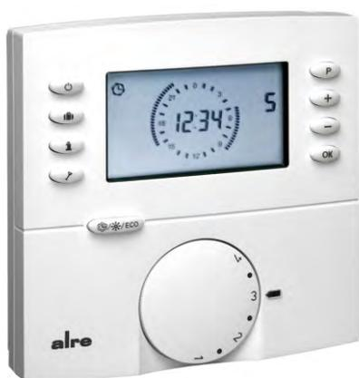
Digitales Raumthermostat mit beleuchtenden Display und Sollwertsteller. Individuelles Tages-Wochenprogramm einstellbar. Party- und Urlaubsfunktion sowie Lernfunktion. Pilotfunktion: Der Regler kann als Master zur Temperaturabsenkung in Kombination mit Slave-Geräten ( FTR, RTBSB, FETR ) eingesetzt werden.
