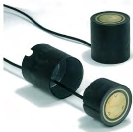
Digitaler Freiflächenfühler zur Erfassung von Feuchte und Temperatur inkl. Fühlerhülse und 15 m Fühlerleitung 4x1mm<sup>2</sup>. Durch Verwendung von digitaler Technik und unter Berücksichtigung des Leitungsquerschnittes, kann die Fühlerleitung bis 500m verlängert werden.
